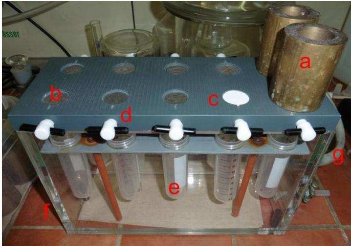
**Abb. 4.2.1-2** Mehrfachfiltrationsgestell mit Einsatz für 50 ml Zentrifugenröhrchen (Eigenbau Universität Rostock) mit a) vergrößerten Filtrieraufsätzen (hier aus Messing), b) Filtersupport aus Stahl, c) handelsüblicher Glasfaserfilter, d) Teflonhahn, e) 50 ml PE-Zentrifugenröhrchen in PVC-Gestell, f) extra hohem Evakuiergefäß und g) Schlauch zur Vakuumpumpe.
