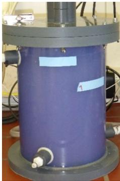
Abbildung 1: Anaerobreaktor zur mesophilen Vergärung der Gülle- und RAS-Schlammproben
